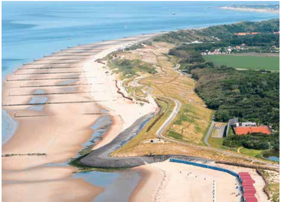
Building with Nature, zoals het gebruik van zandsuppleties, resulteert in een veerkrachtige kust die bescherming biedt tegen stormen, erosie en zeespiegelstijging.
